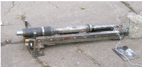
Рисунок 1 – Экспериментальный образец водяной системы пожаротушения импульсного действия
