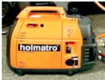
Рисунок 2 Насосная станция DPU 31 PC
