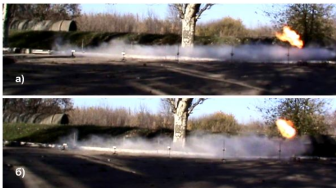
Рисунок 1 – Фотографии полета высокоскоростной струи огнетушащего вещества:
