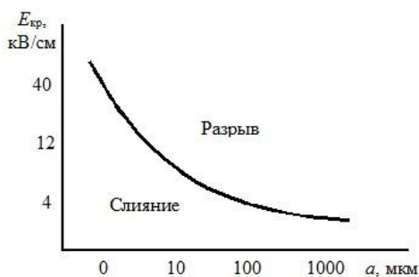
Рисунок 1 – Зависимость критической напряженности поля от радиуса капли
