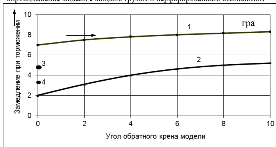
Рисунок 1 – Зависимость замедления, при котором происходит опрокидывание модели от предварительно установленного крена
