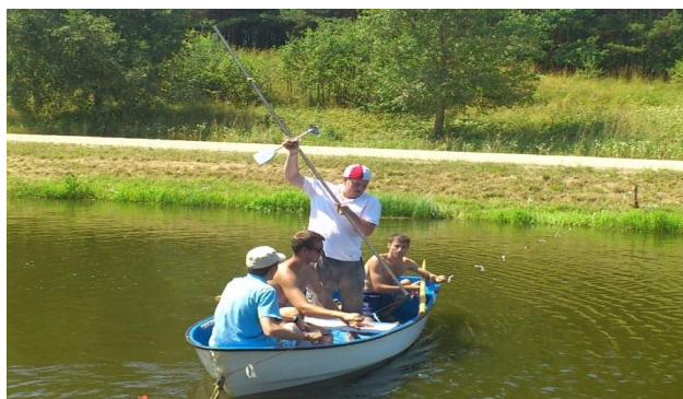
Рис 3. Замеры скоростей при помощи гидрометрической вертушки.
