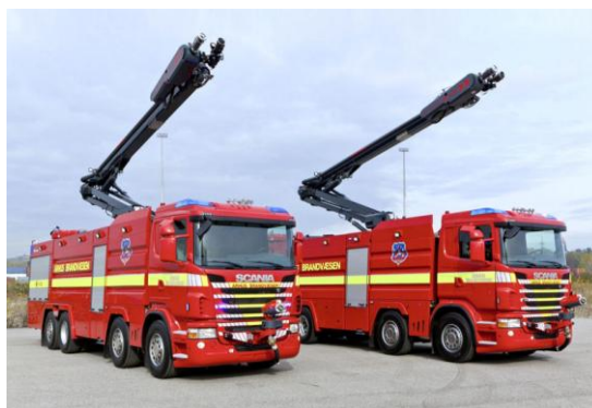
Рисунок 2 – Выдвижная установка дальнего действия Stinger
