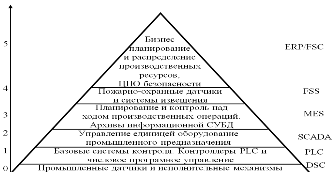
Рисунок 1- Структура сети передачи данных с единым пожарно-охранным и технологическим информационным пространством
