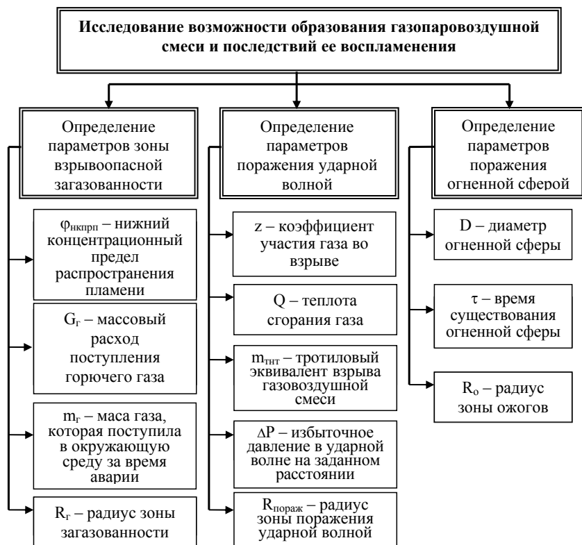
Рисунок. Схема исследования взрыва газопаровоздушных смесей
