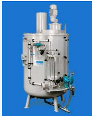
Рисунок 5.2 – Дозатор хімічних добавок
