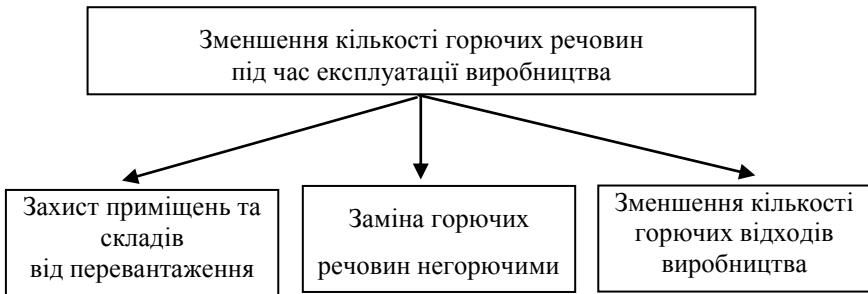
Рисунок 7.2 – Інженерно-технічні рішення щодо зменшення кількості горючих речовин під час експлуатації виробництва
