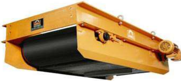
Рисунок 6.27 – Підвісний магнітний сепаратор, що самоочищається
