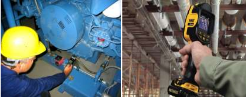
Рисунок 6.33 – Використання портативних пірометрів на виробництві
