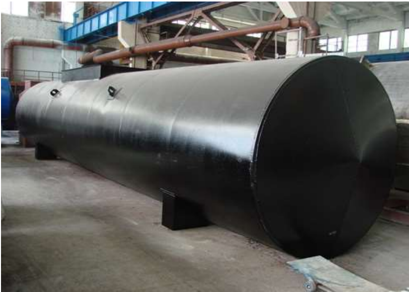
Рисунок 3.3 – Підземний двохстінний резервуар для зберігання світлих нафтопродуктів
