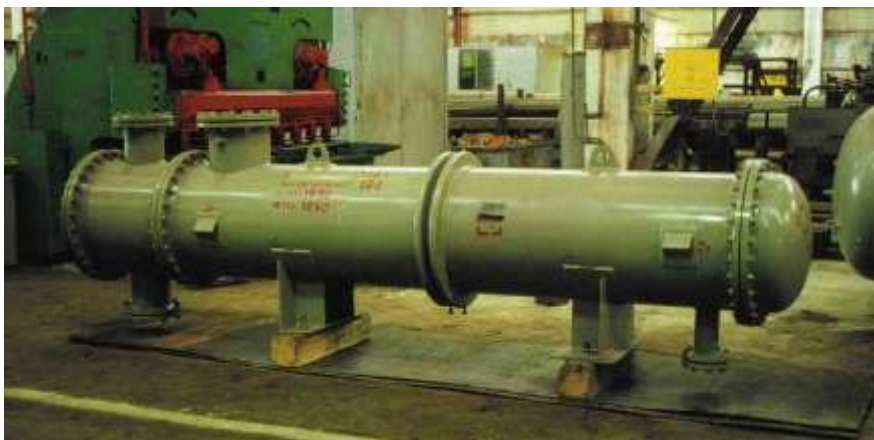
Рисунок 5.29 – Кожухотрубчастий теплообмінник з трубними решітками
