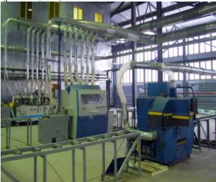
Рисунок 2.19-Система аспірації в процесі деревообробки
