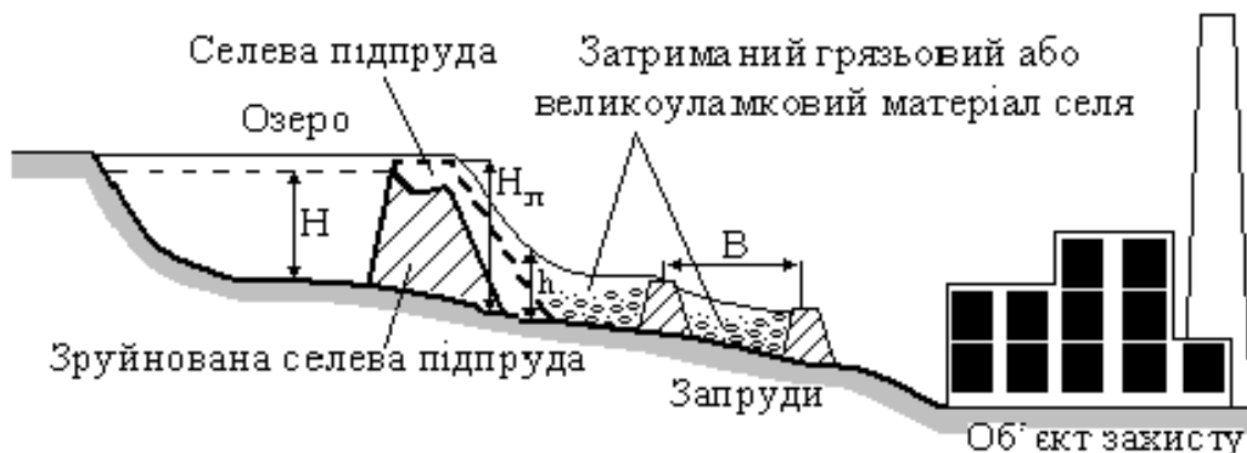
Рисунок 11.3 – Схема затримання селевих виносів та стабілізація русла:
