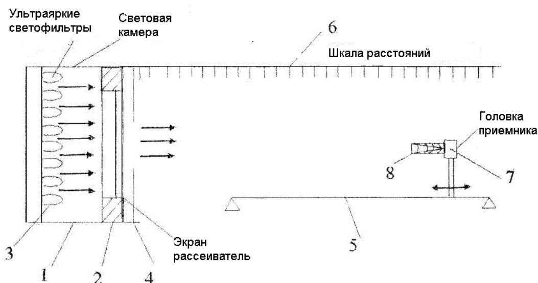
Рис.4 Функциональная схема установки физического моделирования энергетической освещенности.
