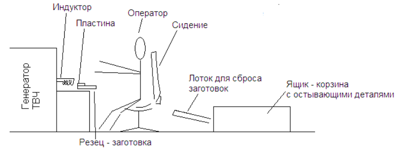
Рис.1. Воздействие высоких температур на рабочее место оператора от установки ТВЧ (источник 11) при технологической операции – пайке.
