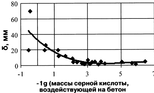
Рис. 2. Влияние массы серной кислоты, воздействующей на бетон на глубину диффузии биогенных кислот за фронт коррозии
