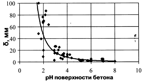
Рис. 3. Влияние кислотности среды на поверхности бетона на глубину диффузии биогенных кислот
