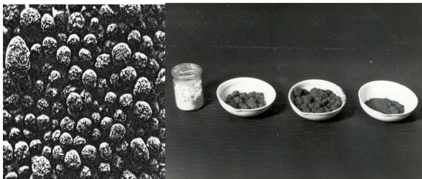
Рисунок 15.2 - Зовнішній вигляд цинкового концентрату, сирих і обпалених гранул і вихідного шламу.
