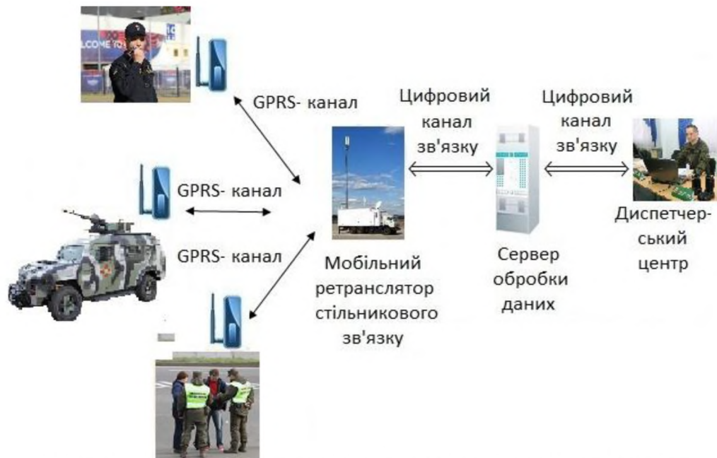
Рис. 3. Передача даних ПЗВД через мобільні ретранслятори стільникового зв'язку.
