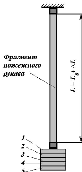
Рис. 1. Дослідна установка із встановленим фрагментом пожежного рукава типу «Т» з внутрішнім діаметром 51 мм
