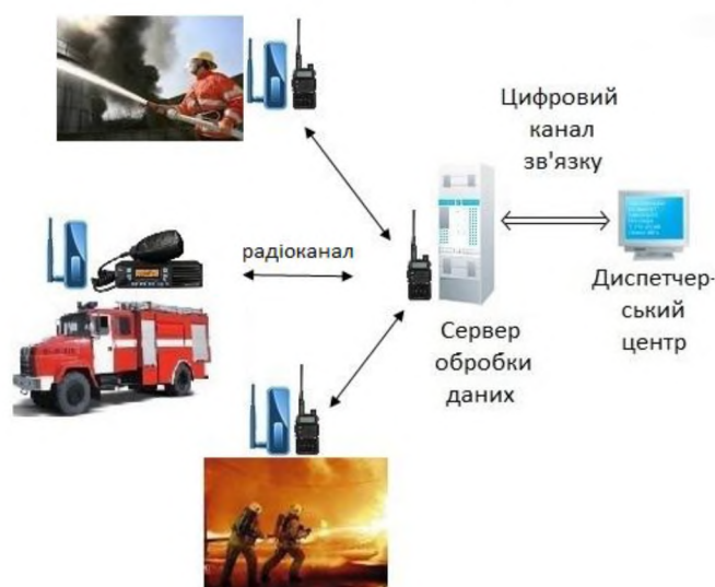
Рис. 2. Передача даних ПЗВІ по радіоканалам управління
