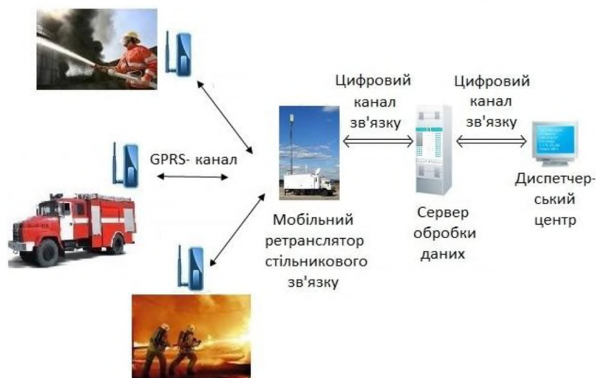
Рис. 3. Передача даних ПЗВІ через мобільні ретранслятори стільникового зв'язку
