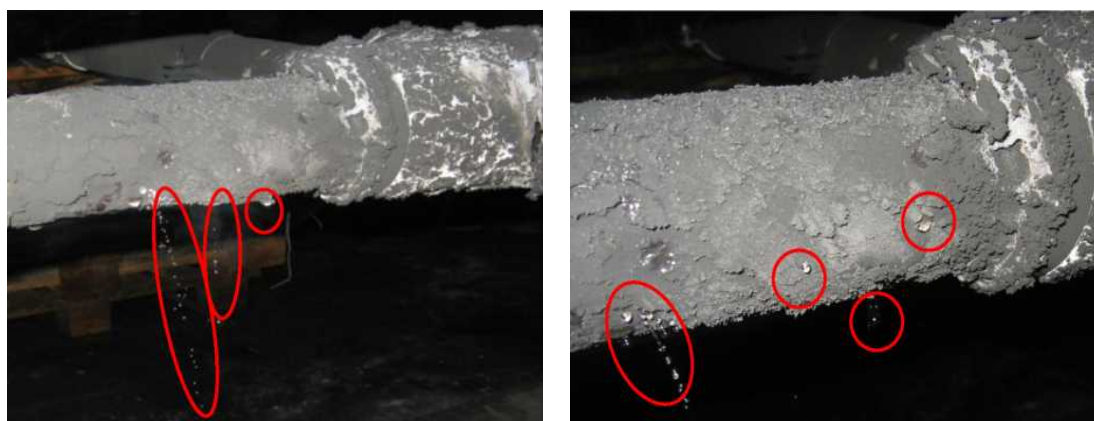
Рис. 1. Результаты испытаний трубопроводной сборки d = 40 мм с проведением контроля протечек воды при гидравлическом давлении равном 1,5 \cdot P_{раб} и 2 \cdot P_{раб} а) фрагмент Т-образной трубопроводной сборки; б) фрагмент линейной сборки
