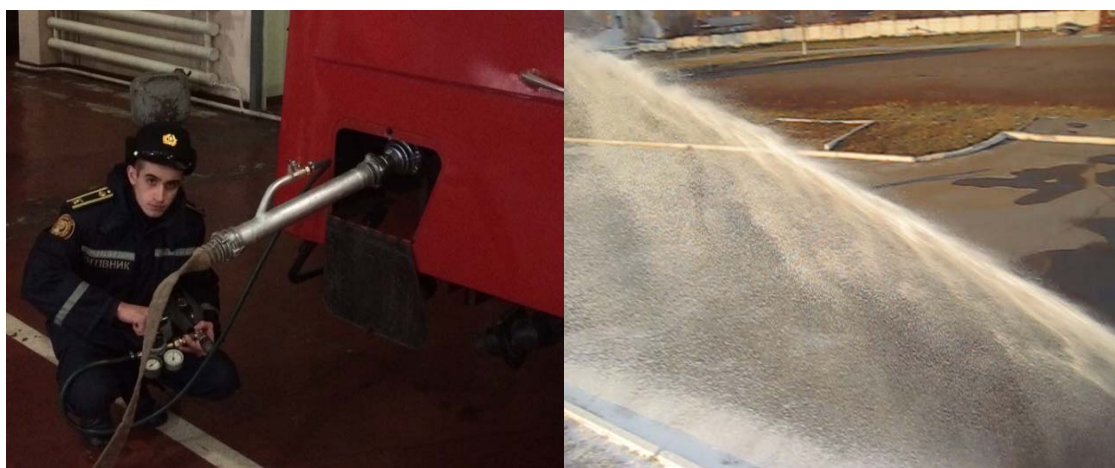
Рис. 1. Фрагмент испытаний подачи компрессионной пены: а – внешний вид струи компрессионной пены; б – внешний вид устройства для подачи сжатого газа в раствор пенообразователя
