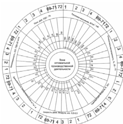
Рис. 6.18 Диаграмма условий труда рабочих обжига кирпича и стекловарочного цеха – Ново-Александровка: 1 – обжиг кирпича в печи; 2 – выгрузка готовой продукции; 3 – контроль технологических параметров; 4 – внешний осмотр лючков и свода печи; 69-71 – загрузка-выгрузка при открытом окне; 72 – отпуск деталей
