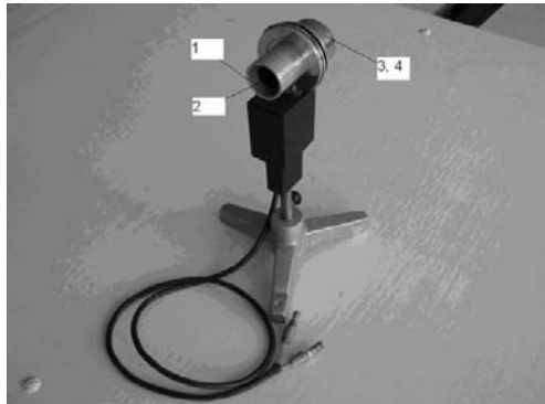
Рис. 3.7. Общий вид усовершенствованной приемной головки: 1 – корпус; 2 – подвижная диафрагма; 3, 4 – подвижная система с приемником
