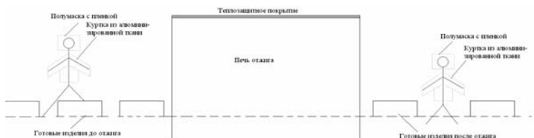
Рис. 6.13. Теплозащита рабочих мест у обжиговой печи
