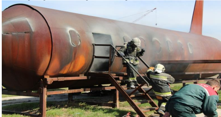
Рисунок 1. Тренажер ликвидации аварий на воздушных судах
