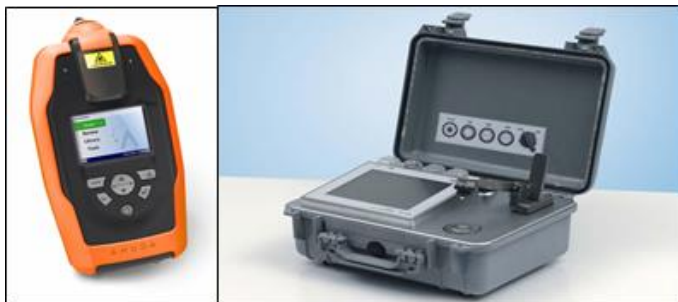
Рис. 2. Спектрометр First DEFENDER (рамановский) И спектрометр Mobile IR (инфракрасный)
