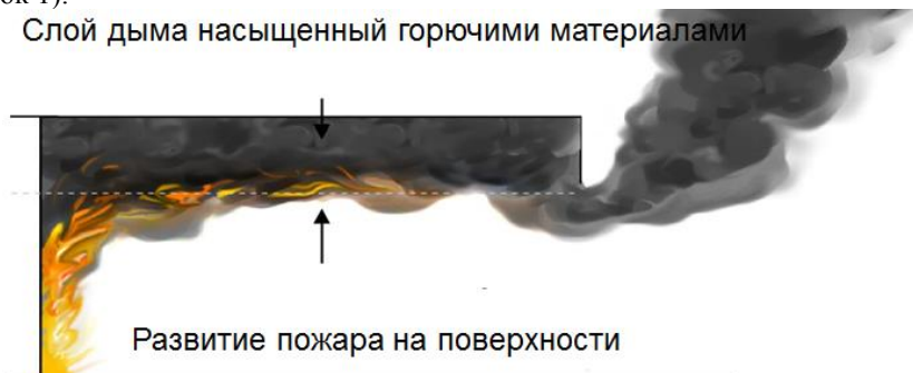
Рисунок 1 – Общий вид горящего помещения
