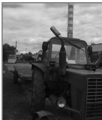
Рисунок 3 – Искрогаситель (выхлопная система МТЗ-80)
