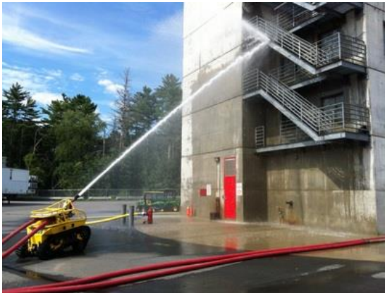
Рисунок 4. – Подача компактного струменя за допомогою Thermit 3.0
