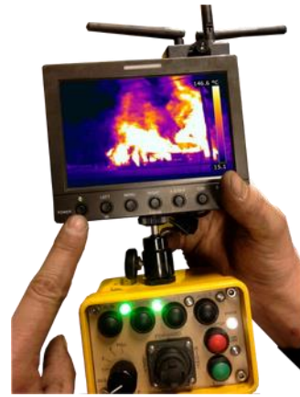
Рисунок 3. – Пульта дистанційного керування Thermit 3.0
