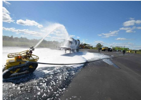
Рисунок 5. – Подача піни за допомогою Термітом 3.0
