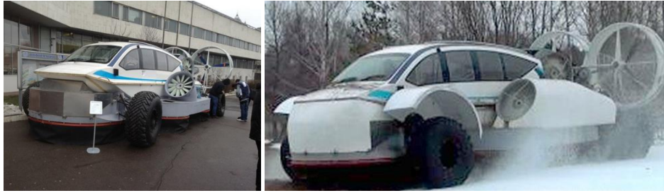
Рис. 4. Експериментальний прототип «Транспортного средства с воздушной разгрузкой»
