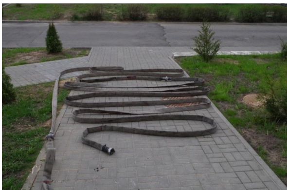
Рисунок 1 – Рукав для маневрирования при входе в здание
