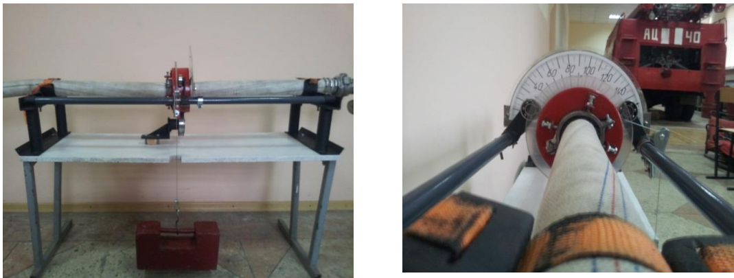
Рис. 2. Фотографії проведення досліджень кута закручування НПР
