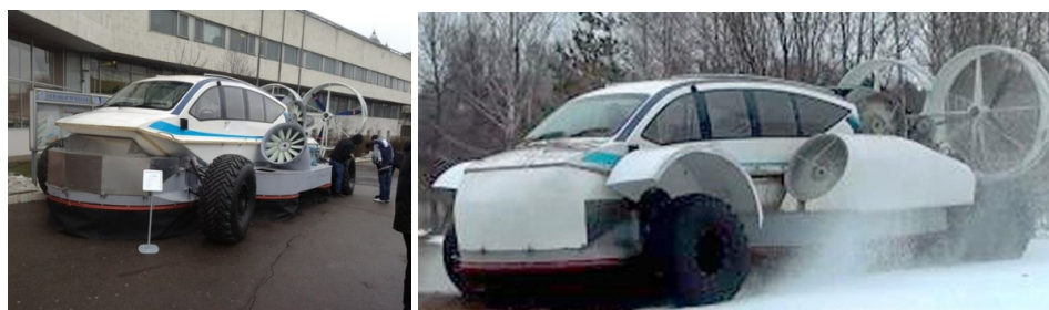
Рис. 4. Экспериментальный прототип «Транспортного средства с воздушной разгрузкой»
