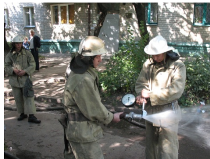
Рис. 1. Методика вимірювань фактичних витрат води з водопроводу за тиском у патрубку пожежної колонки
