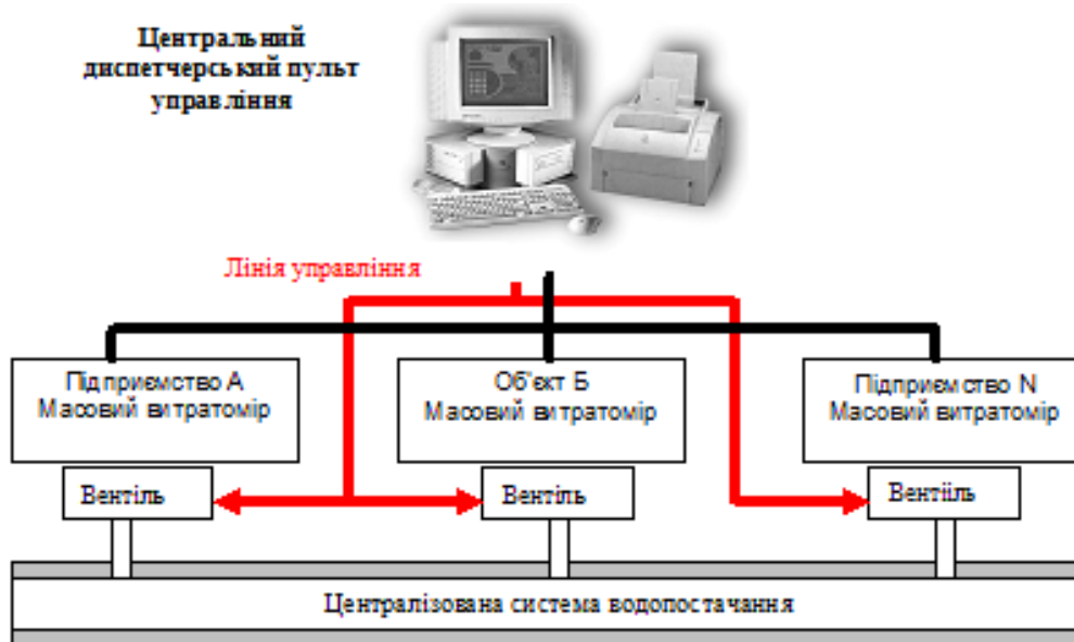
Рис. 4. Схема побудови системи управління та контролю при застосуванні масового витратоміра
