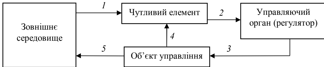
Рис. 1. Типова схема саморегульовальної системи: 1 – вихідна інформація про стан середовища (попередня, поточна і наступна); 2 – оброблена інформація; 3 – управляюча інформація; 4, 5 – зворотні зв'язки
