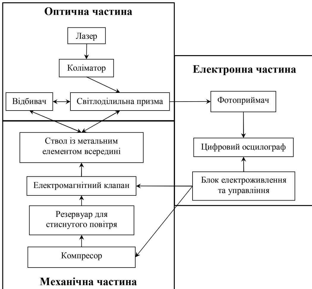
Рис. 4. Структурна схема експериментальної установки
