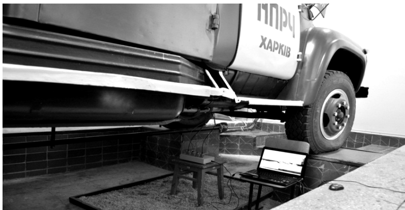
Рис.3. Визначення температури вихлопної труби пожежного автомобіля марки АЦ-40(130)63Б, що є нерухомим, а ДВЗ працює під навантаженням
