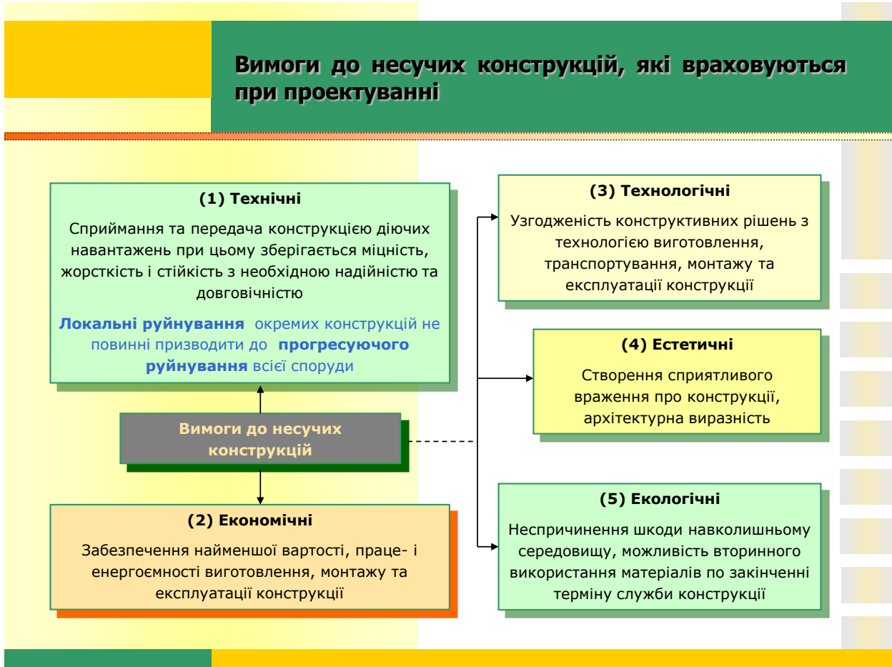
Рисунок 2.8 – Вимоги до конструкцій будівель
