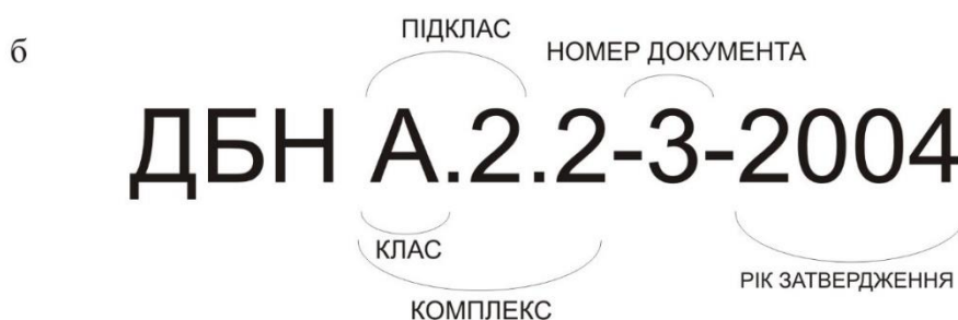
Рисунок 4.1 – Класифікація державних будівельних норм України (ДБН): а – схема класифікації; б – структура класифікаційного коду нормативного документа
