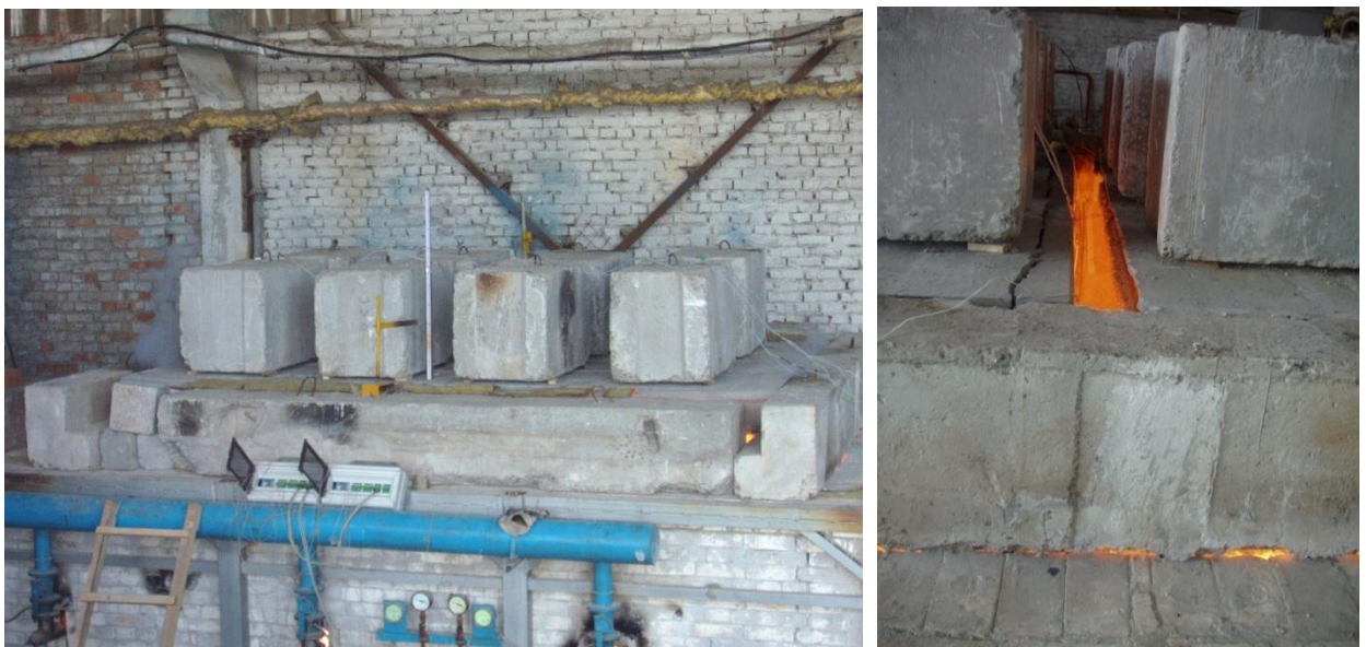
Рисунок 6.2 – Випробування на вогнестійкість
