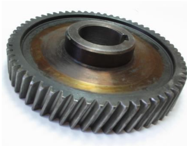
Рисунок 3.2.2 – Зовнішній вигляд косозубого зубчастого колеса
