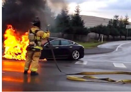
Рис. 2 – Горіння літій-іонних акумуляторів на електромобілях
