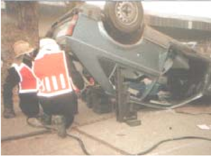
Рис. 4.10 – Фіксація перекинутого автомобіля
