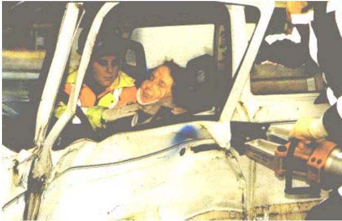
Рис. 4.1- Відкриття дверей для вилучення постраждалого
