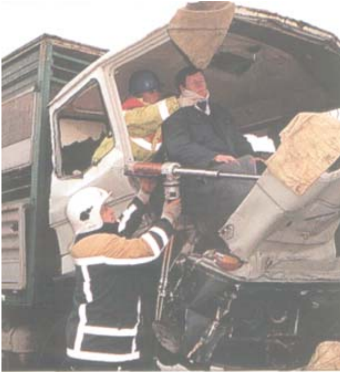
Рис. 4.15 – Прийом деблокування постраждалого з кабіни вантажного автомобіля
