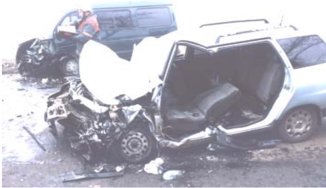
Рис. 4.4 – Видалення обох дверей з однієї сторони
