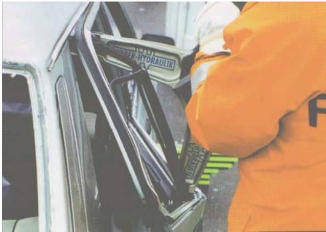
Рис. 4.2 – Розширення віконного прорізу дверей
