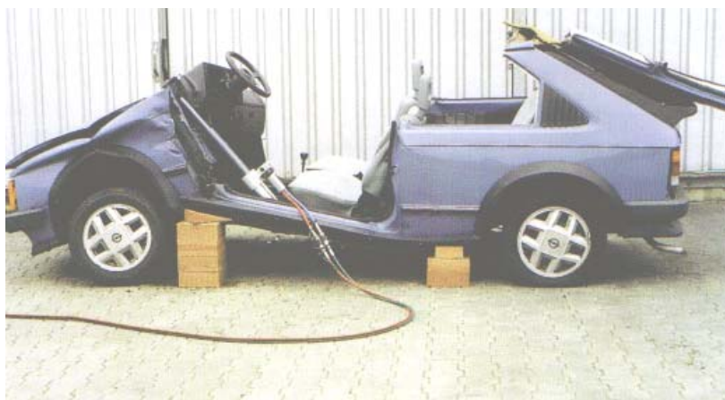
Рис. 4.6 – Приклад видалення даху з завертанням назад
