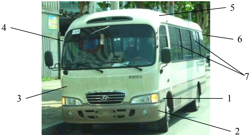
Рис. 3.3 – Елементи кузова автобуса важливі під час проведення рятувальних робіт: 1 – підніжка; 2 – Бампер; 3 – передня панель; 4 – передня стійка; 5 – дах; 6 – задня стійка; 7 – середні стійки
