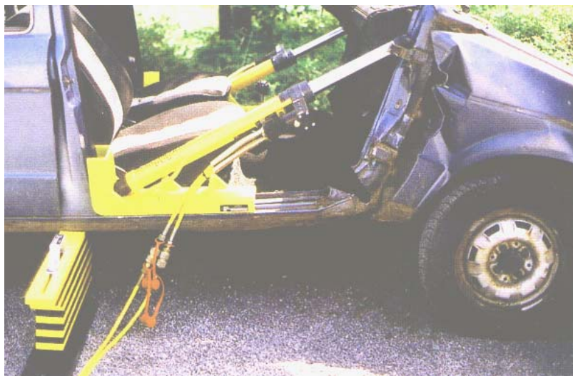
Рис. 4.11 – Віджимання передньої частини автомобіля
