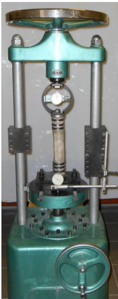
Рис. 1. Дослідна машина ДМ-30М із встановленим зразком рукава
