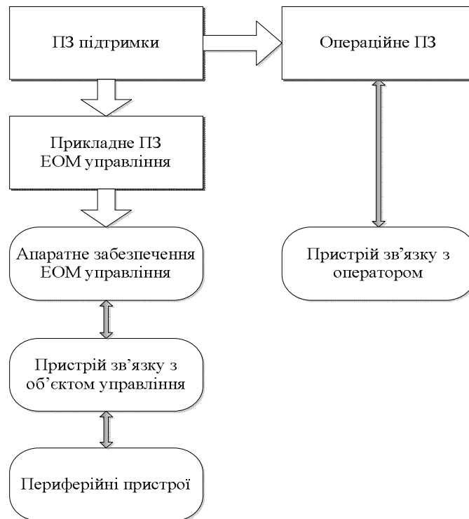
Рис. 2. Схема взаємодії апаратних засобів та ПЗ КС ОКЗ
