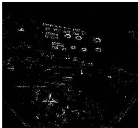
Рис. 10. Результат сегментування методом Канні зображення I_{\text{ш}}^{\text{адд}}(i, j) , що спотворене АБГШ з нульовим середнім та заданим середньоквадратичним відхиленням \sigma = 0,25 (рис. 4)
