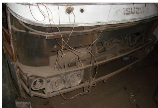
Рисунок 12 – Незначні прояви корозії каркасу передньої частини автобуса «Богдан А-092»: а) після дев'яти років експлуатації; б) після п'яти років експлуатації
