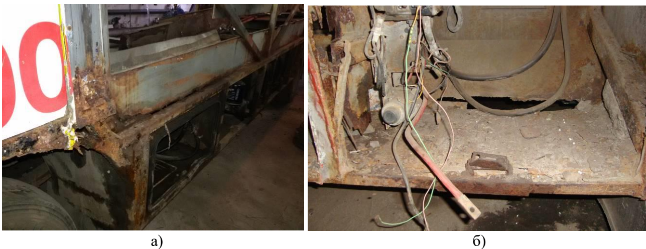
Рисунок 10 – Корозія лівої боковини автобусів «Богдан А-092»: а) термін експлуатації 10 років; б) термін експлуатації 9 років (корозія акумуляторного відсіку)
