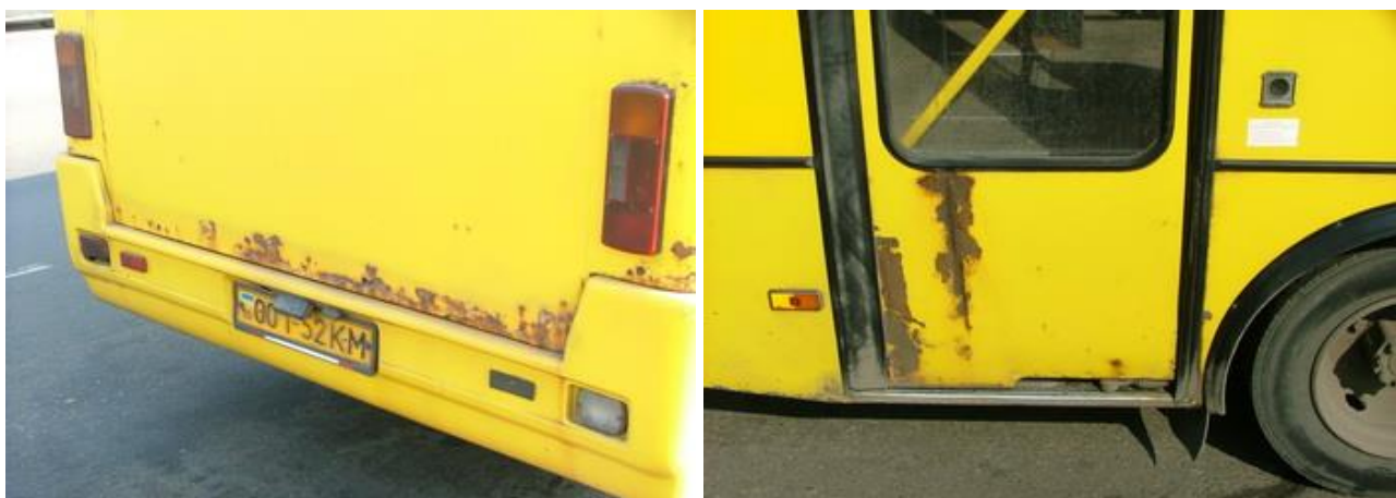
Рисунок 16 – Корозія облицювання автобуса «Еталон А-079» після п'яти років експлуатації: а) корозія заднього облицювання; б) корозія задніх пасажирських дверей [2]
