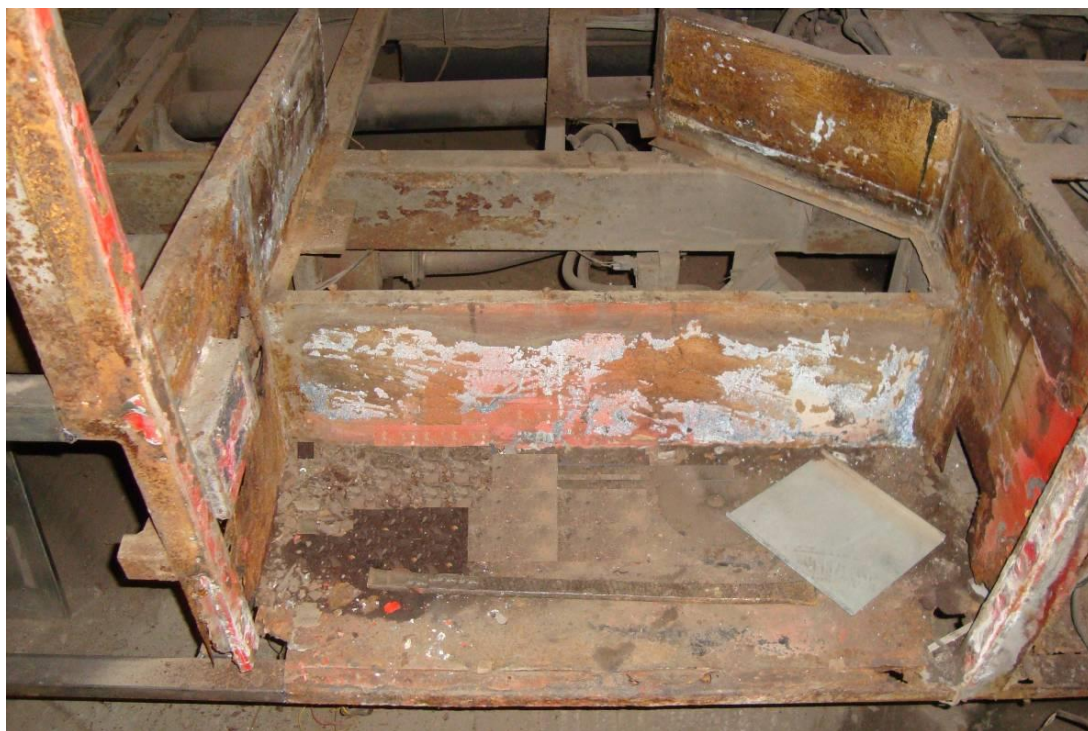
Рисунок 13 – Корозія каркасу передньої пасажирської сходинок автобуса «Богдан А-092» після дев'яти років експлуатації
