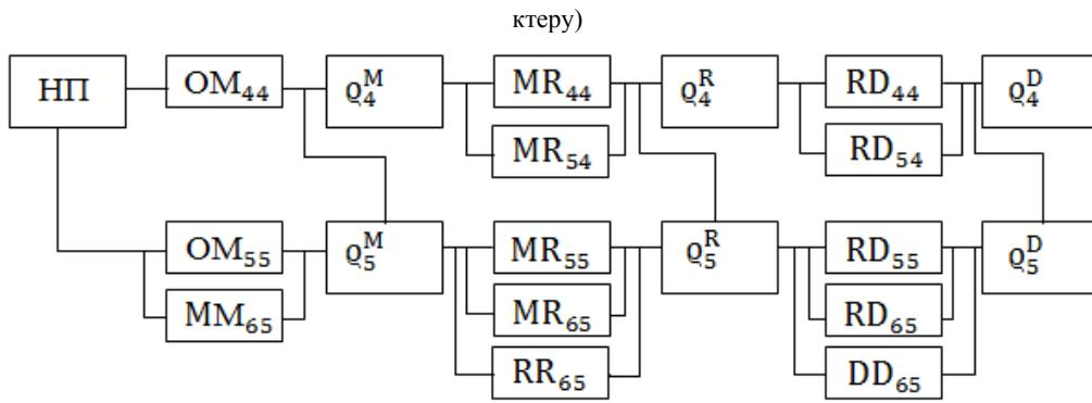
Рис. 3 – Еквівалентна схема з функціональним резервуванням інформаційно-комунікативної взаємодії поширення наслідків  $\rho_4$  та  $\rho_5$  НС МБ характеру. ( $MR_{54} \dots RD_{65}$  – еквівалентні інформаційно-комунікативні елементи в напрямку поширення негативних наслідків)
