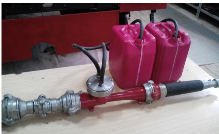
Рис. 7. Внешний вид переносного устройства эжекционного типа для получения огнетушащего геля
