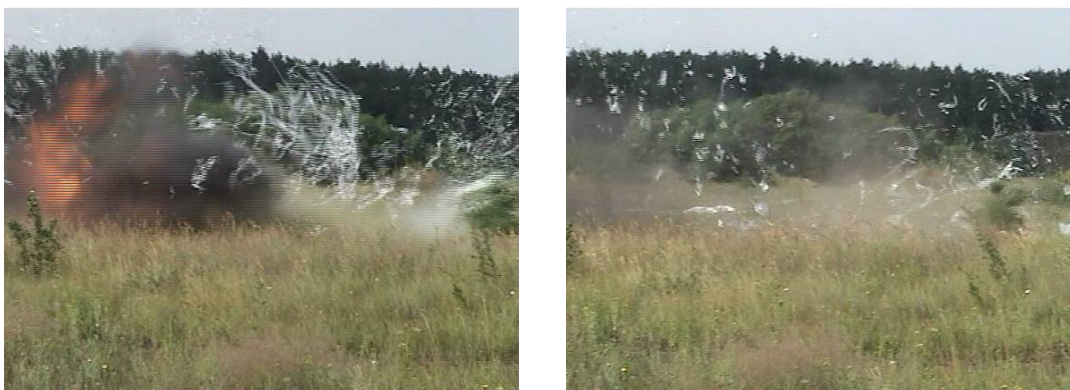
Рис. 4 – Разлет продуктов детонации и оболочки заряда
