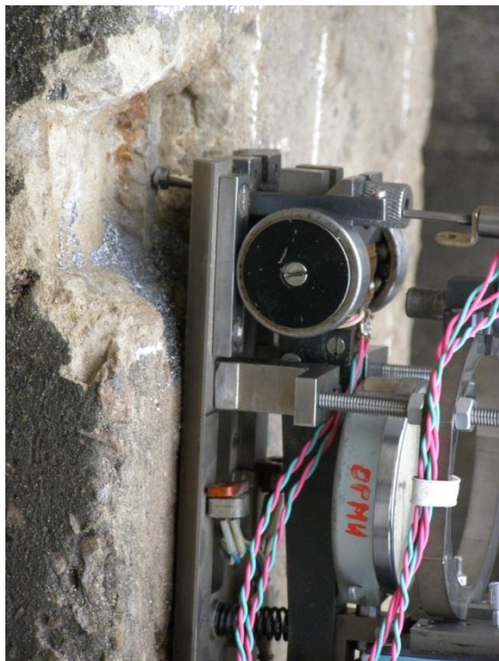
Рис. 2 – Висмикування випробувального гвинта.
