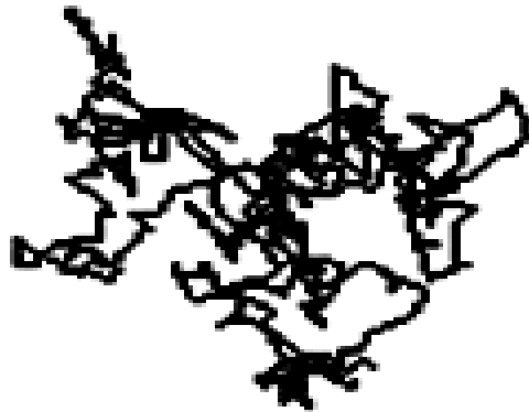
Рис. 2 - Характерная траектория движения локального максимума пространственно неоднородного распределения интенсивности отраженного от решетки светоотражателей лазерного излучения в плоскости приемного устройства
