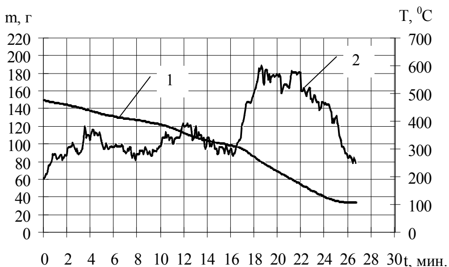
Рис. 1 - Зависимость массы и температуры в верхнем патрубке зонты керамической трубы образца древесины обработанного ДСА-2 при его сгорании
