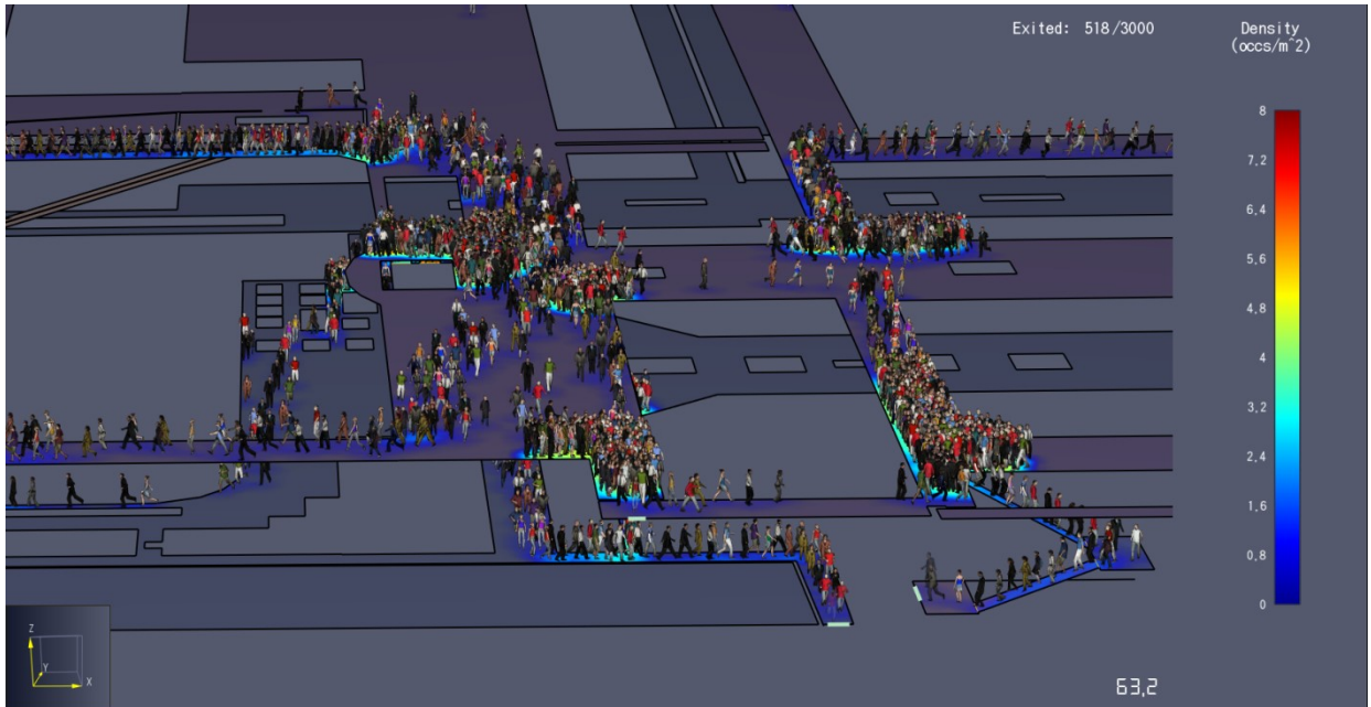
Рисунок 1. Приклад візуалізації евакуації людей програмою Pathfinder.
