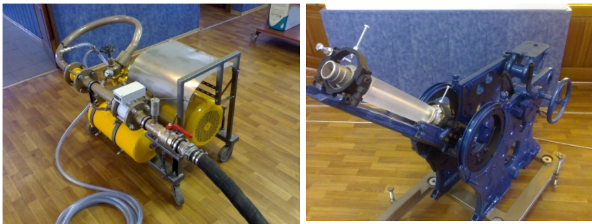
Рис.2. Генеруючий і формуючий блоки експериментального стенду по дослідженню вільних гідравлічних струменів
