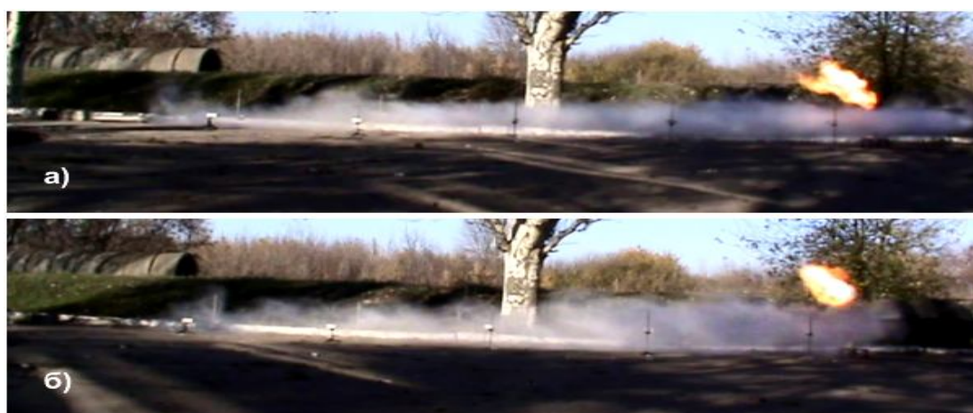
Рис. 1. Фотографии полета высокоскоростной струи огнетушащего вещества: а) вода; б) ФСГ-2
