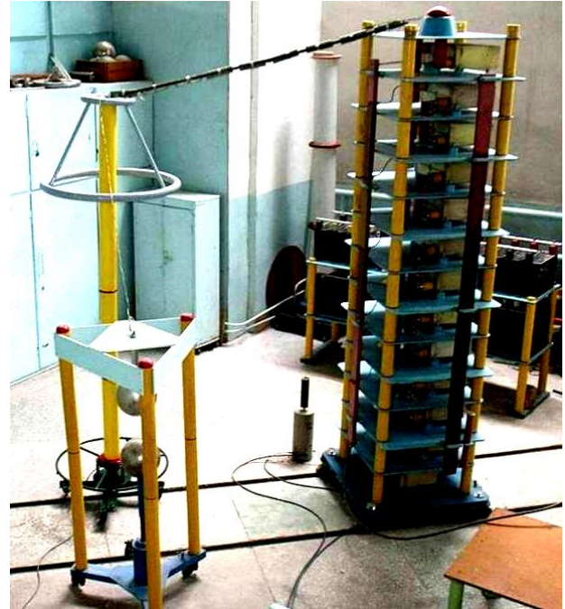
Рис. 11. Общий вид высоковольтного испытательного стенда НИПКИ “Молния” НТУ “ХПИ”, на испытательном поле которого размещены передвижные генератор импульсных напряжений типа ГИН-1,2, делитель типа ОДН-1 и стандартные измерительные шары диаметром 250 мм [17]
