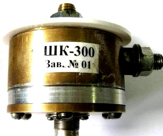
Рис.1. Внешний вид усовершенствованного коаксиального дискового шунта типа ШК-300М1, предназначенного для измерения в микро- и миллисекундном диапазонах затухающих синусоидальных и аperiodических импульсов тока искусственной молнии амплитудой до ±220 кА в сильноточной разрядной цепи мощного высоковольтного ГТМ с интегралом их действия до 3 \cdot 10^6 Дж/Ом [10]
