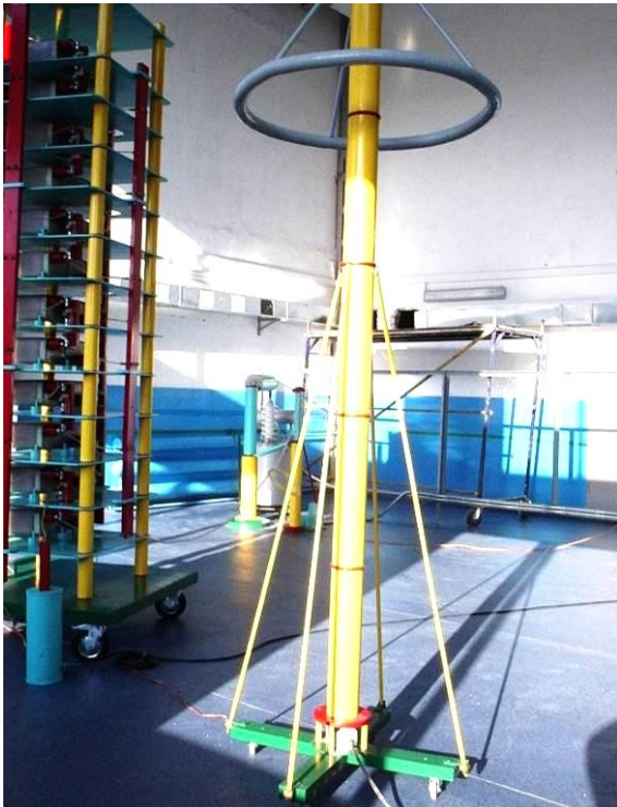
Рис. 10. Общий вид передвижного сверхвысоковольтного омического делителя напряжения типа ОДН-1,2 на номинальное напряжение \pm 1,2 МВ, размещенного на заводском испытательном поле высоковольтного испытательного стенда СВИ-1,2, предназначенного для определения в лабораторных условиях импульсной электрической прочности полимерной изоляции собственного производства (пред-
