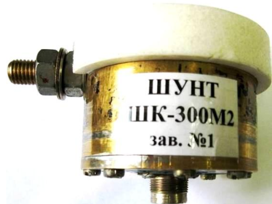
Рис. 2. Внешний вид усовершенствованного коаксиального дискового шунта типа ШК-300М2, предназначенного для измерения в согласованном режиме работы его кабельной линии передачи сигнала в микро- и миллисекундном диапазоне импульсов тока искусственной молнии амплитудой до ±220 кА в сильноточной разрядной цепи высоковольтного ГТМ с интегралом их действия до 15 \cdot 10^6 Дж/Ом [11]
