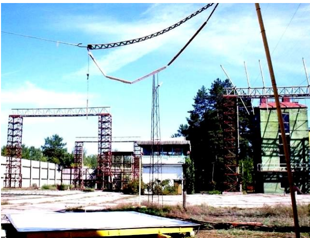
Рис. 14. Общий вид сверхвысоковольтного омического делителя напряжения типа ОДН-2,5 на номинальное напряжение \pm 2,5 МВ, подсоединенного в разрядной цепи ГКИН к двухэлектродной системе “игла-плоскость” с длиной воздушного промежутка 3 м (верхний стальной стержень-электрод этой электроразрядной системы размещен по центру ее нижнего плоского электрода, выполненного из тонкой оцинкованной стали с размером в плане 5 м x 5 м) [23]
