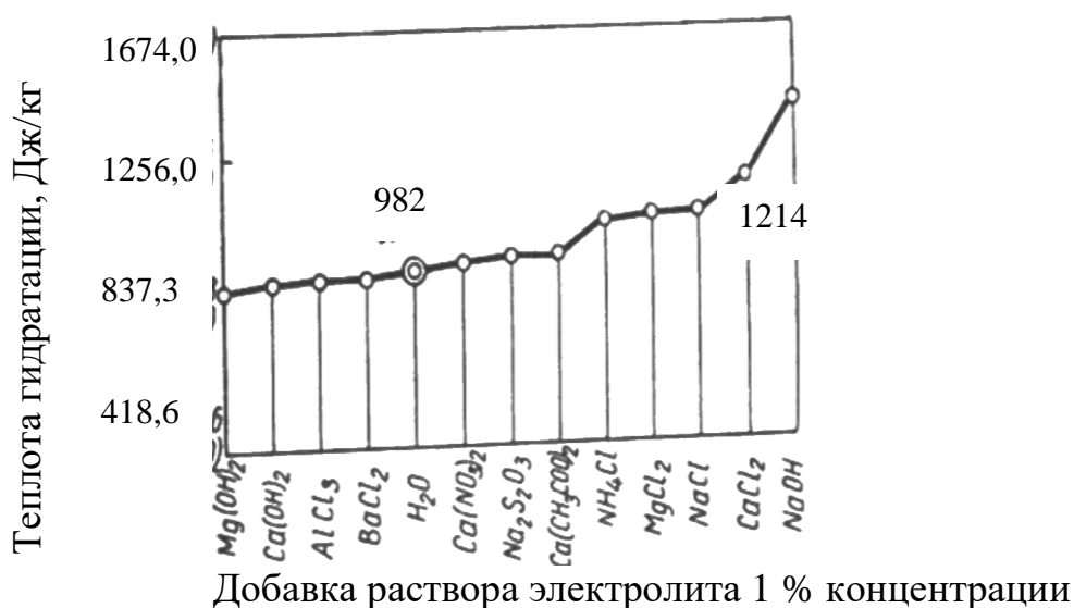
Рис. 1.6 – Изменение теплоты гидратации извести в зависимости от неорганических добавок
