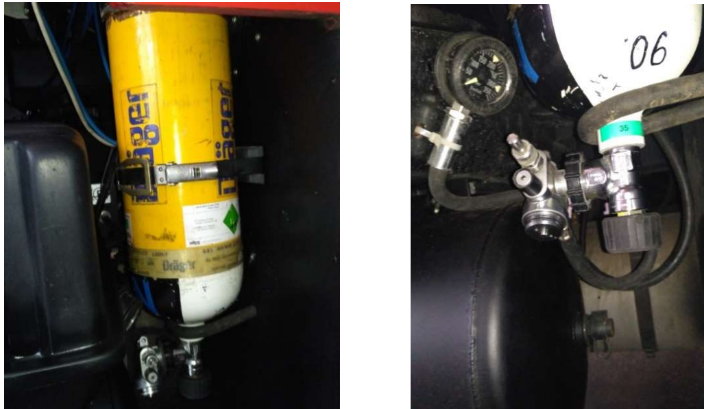
Рис.2. Розміщення повітряного балону зі стисненим повітрям на АЦ – 4 – 60 (5309) – 505М
