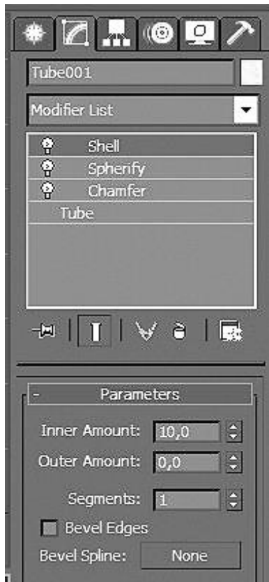
Рис. 2.3. Параметри об'єкта Tube на вкладці Modify під стекем модифікаторів
