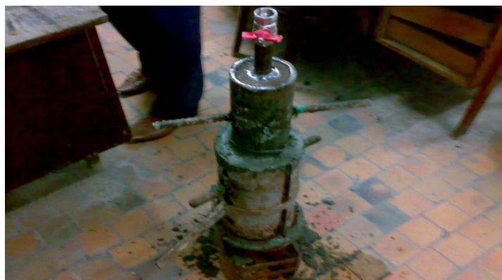
Рис. 1. Лабораторная установка для изготовления бетонных и железобетонных труб способом виброввакуумирования
