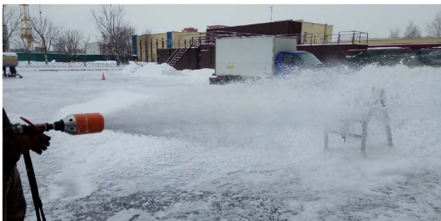
Рисунок 4. – Исследование кратности пены пеногенератора
