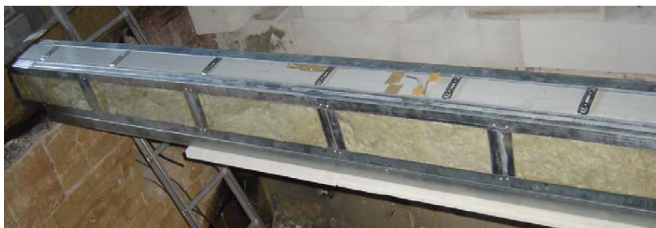
Рисунок 2 – Фрагмент экспериментальных исследований полимерной балки с огнезащитой
