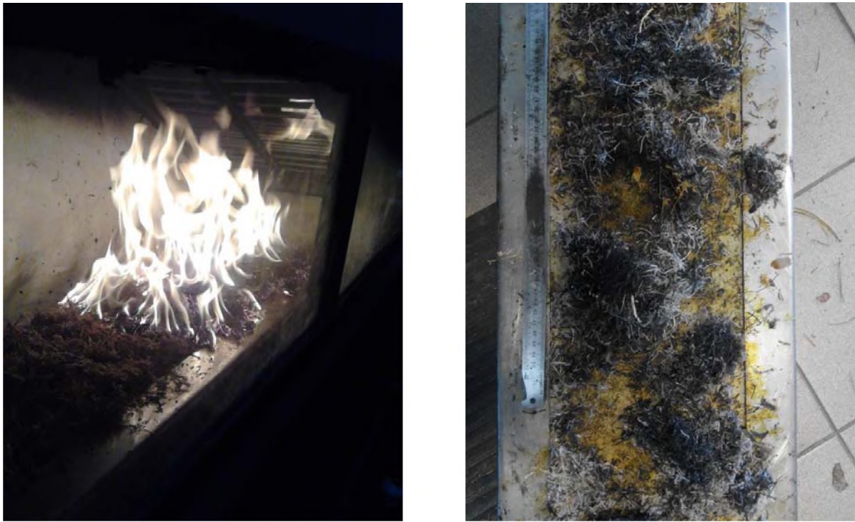
Рисунок 1. – Общий вид проведения испытаний процесса распространения пламени по слою наземного ЛГМ
