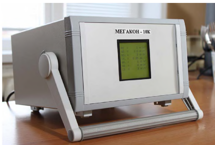
Рисунок 2. – Универсальный газоанализатор Мегакон-10К
