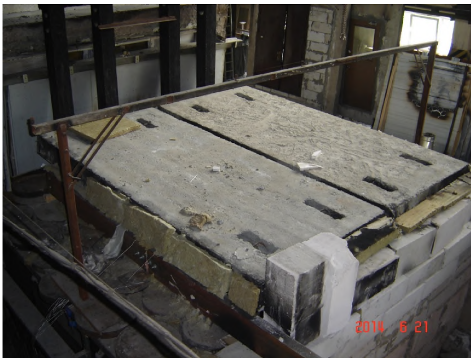
Рисунок 3 – Вид испытаний композитной балки под нагрузкой
