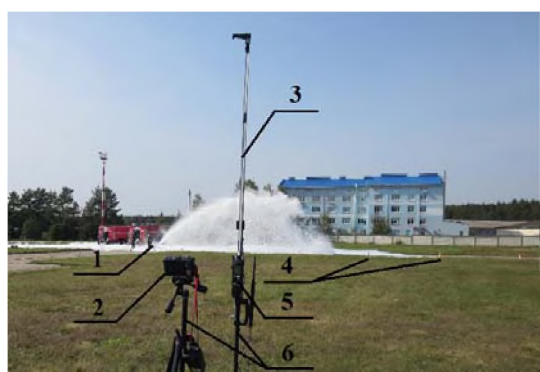
1 – ЛС; 2 – видеокамера; 3 – линейка; 4 – маяки; 5 – анемометр; 6 – штативы Рисунок 1. – Общий вид экспериментальной установки
