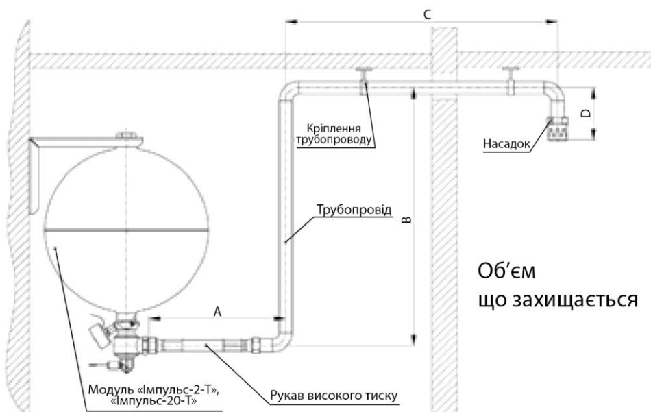
Рис. 2.13 – Умовна схема монтажу модуля з використанням трубопроводу
