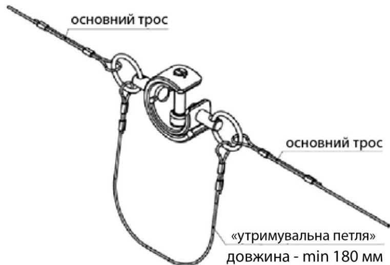
Рис. 5.4 – Монтаж тросової системи детектора з термочутливим замком
