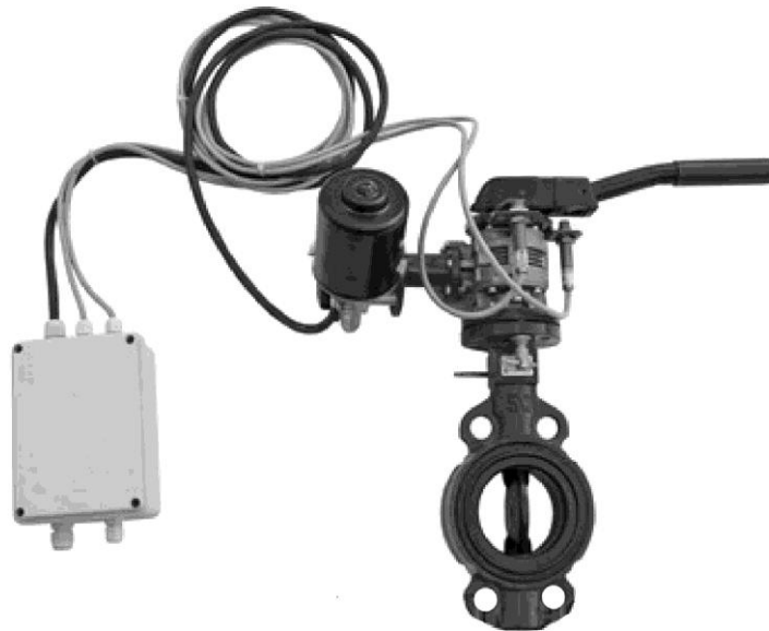
Рис. 1.46 – Дискові затвори з електроприводом Ду80 (12;24 В)
