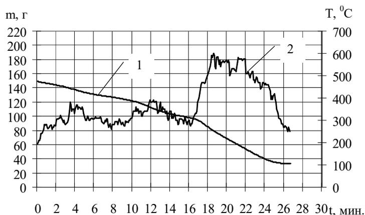
**Рис. 1. Зависимость массы и температуры в верхнем патрубке зонта керамической трубы образца древесины обработанного ДСА-2 при его сгорании:
