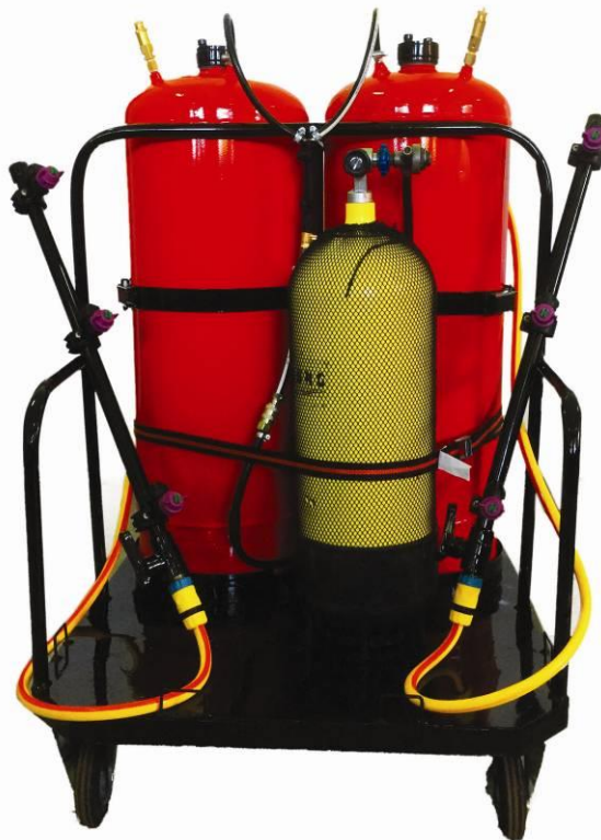
Рис. 1. Зовнішній вигляд установки: 1 – ємність для компонентів бінарної системи; 2 – балон зі стиснутим повітрям; 3 – металева платформа з каркасом; 4 – редуктор; 5 – лінії подачі компонентів; 6 – насадки
