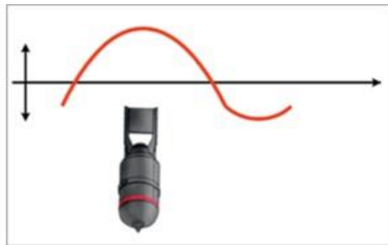
Рисунок 2 – Особливості сигналу глибинного магнітометра при виявленні вертикально розташованого об'єкта
