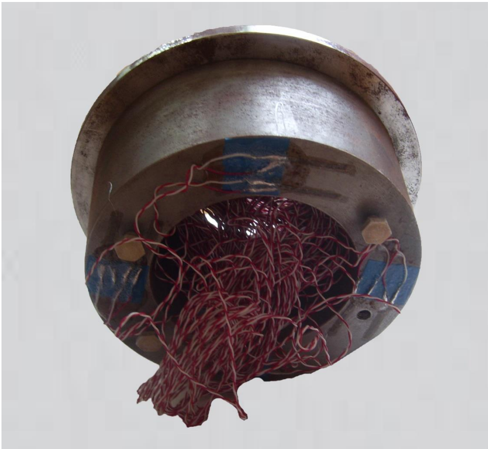
Рис. 5.2 Колесо одноробордне з конічним ободом
