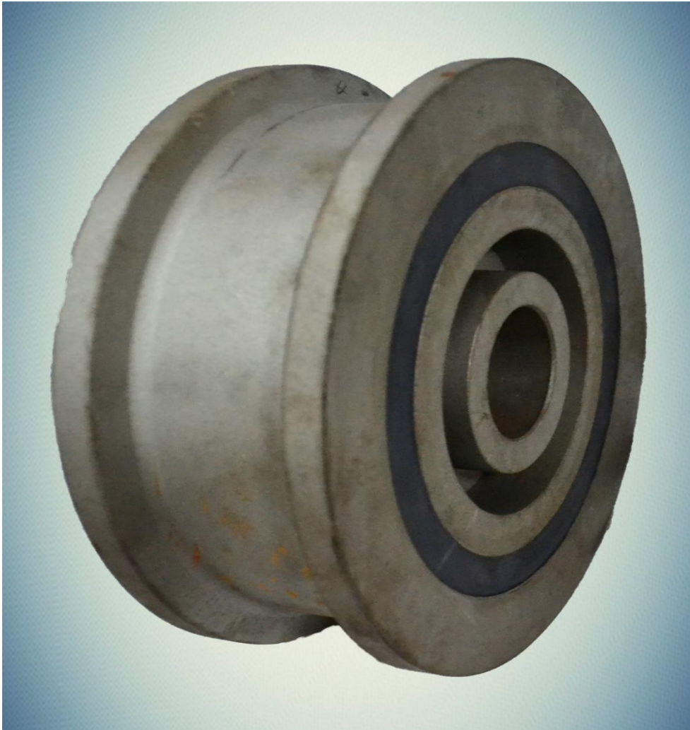
Рис. 3.1 Колесо ходове кранове з пружним кільцем, розташованим в ободі
