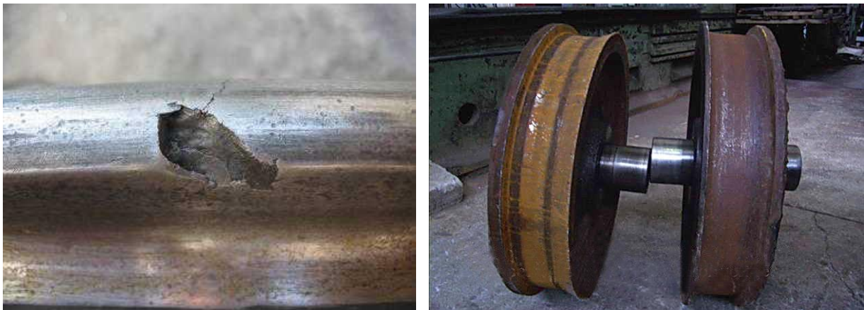
Рис. 1.1 Зношені реборди кранових коліс
