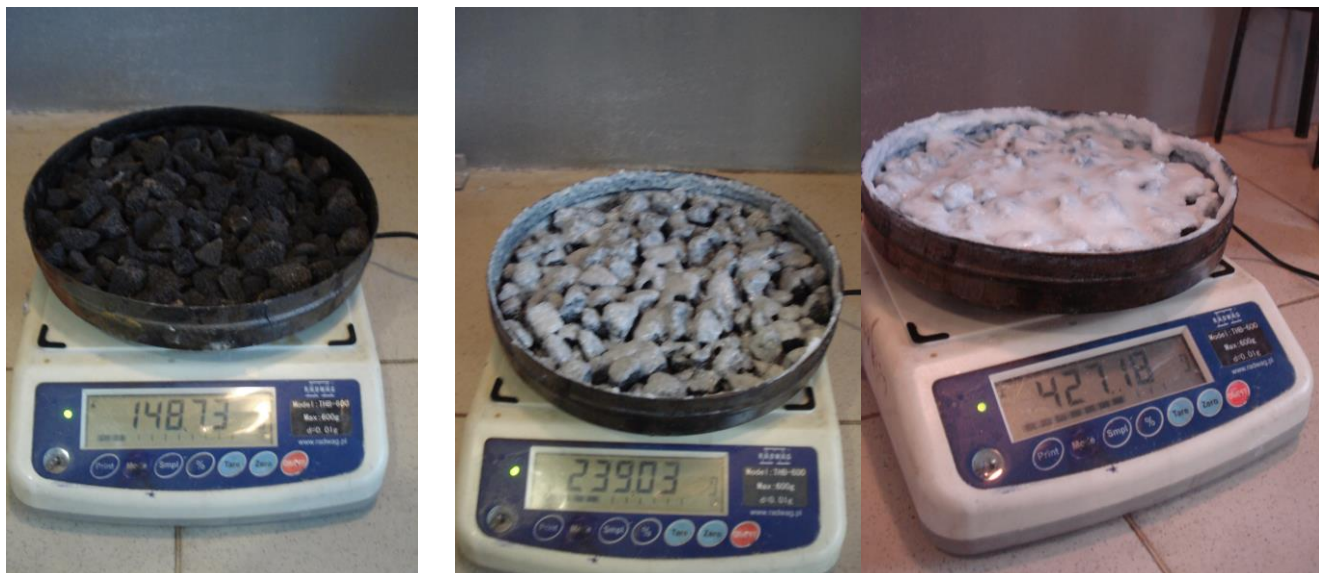
Рис. 6. Вогнегасні системи на основі піноскла для гасіння пожежі класу В: а) гасіння піносклом; б) гасіння піносклом з не суцільним шаром гелю; в) гасіння піносклом з суцільним шаром гелю
